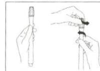
1 - 2) Tenez la sonde verticalement pour que le bouchon soit orienté vers le haut et ouvrez l'emballage en tournant le bouchon. Veillez à conserver le bouchon à portée de main.
