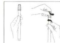
1 - 2) Tenez la sonde verticalement pour que le bouchon soit orienté vers le haut et ouvrez l'emballage en tournant le bouchon. Veuillez à conserver le bouchon à portée de main.
